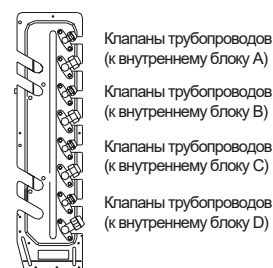
Рисунок 43 - Клапаны трубопроводов внешнего блока системы «1-4»
